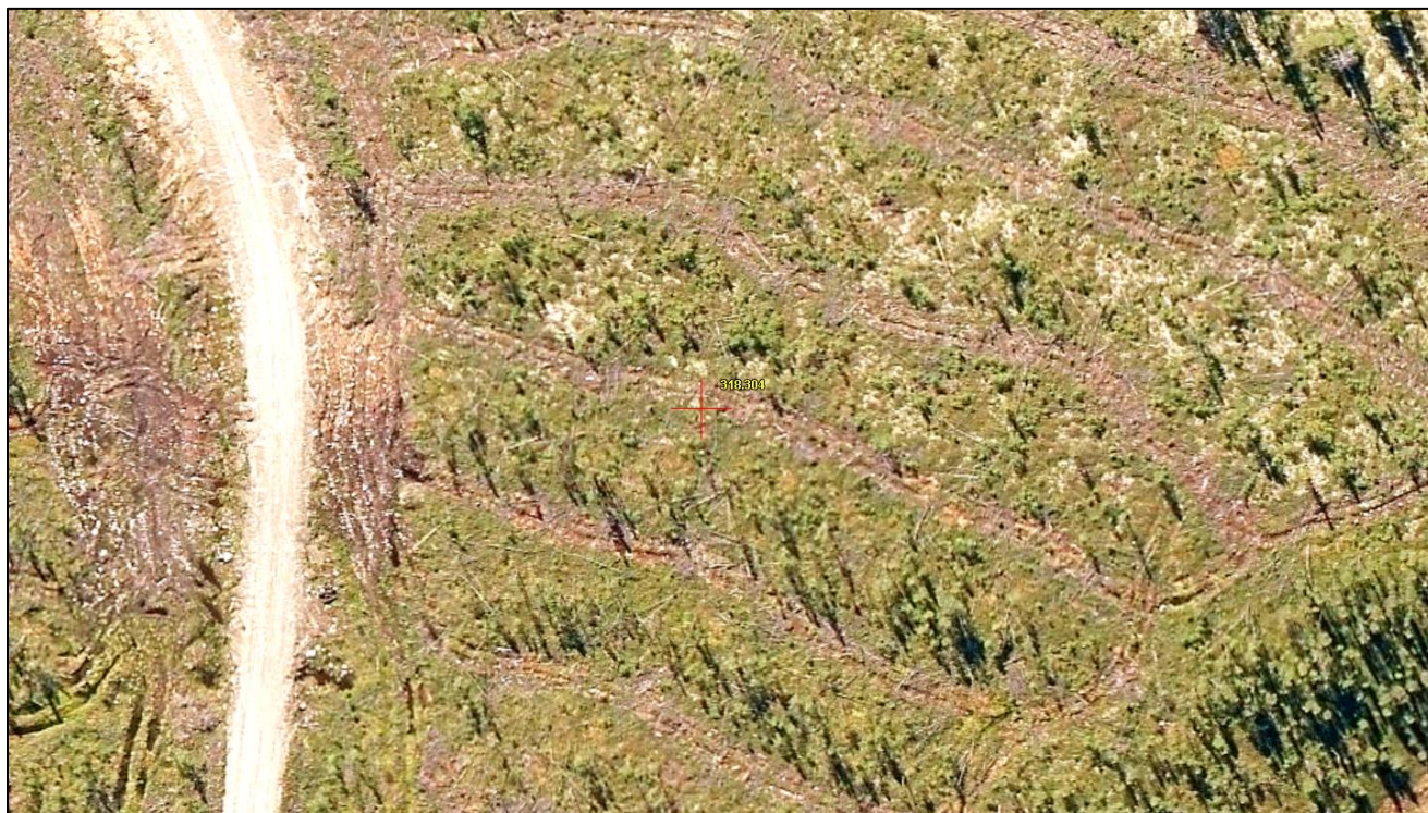
Figure 105. Exemple d'une photographie aérienne avec un rehaussement de base modifié (Essai 1) dans une CPRS de la pessière à mousse de l'Ouest (paramètres de rehaussement : luminosité : -20; contraste : 35; saturation : 20; netteté : 10). Échelle approximative : 1/1000.
