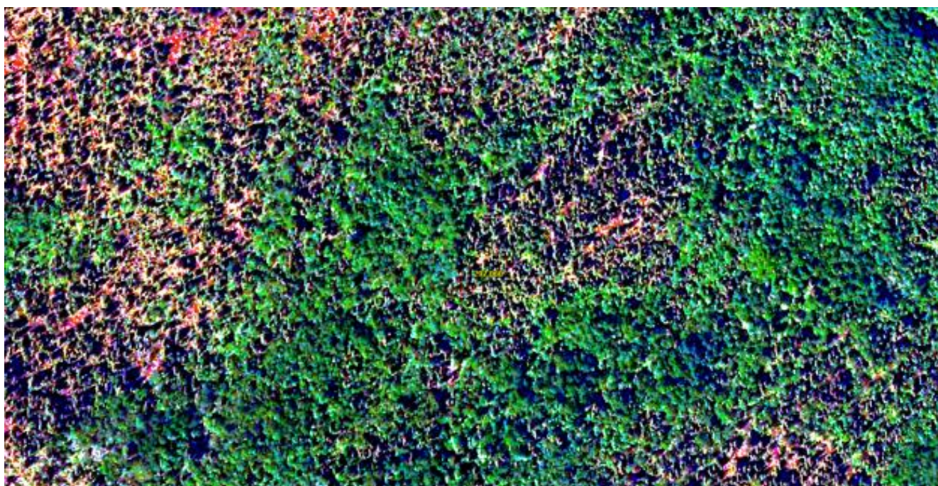
Figure 116. Exemple d'une photographie aérienne avec rehaussement de base modifié (Essai 1) dans un peuplement mixte au stade gaulis de la sapinière à bouleau blanc de l'Ouest (paramètres de rehaussement : luminosité : -11; contraste : 55; saturation : 33; netteté : 10; coché « Contrast Stretch », Std Dev à 2.7). Échelle approximative : 1/1400.
