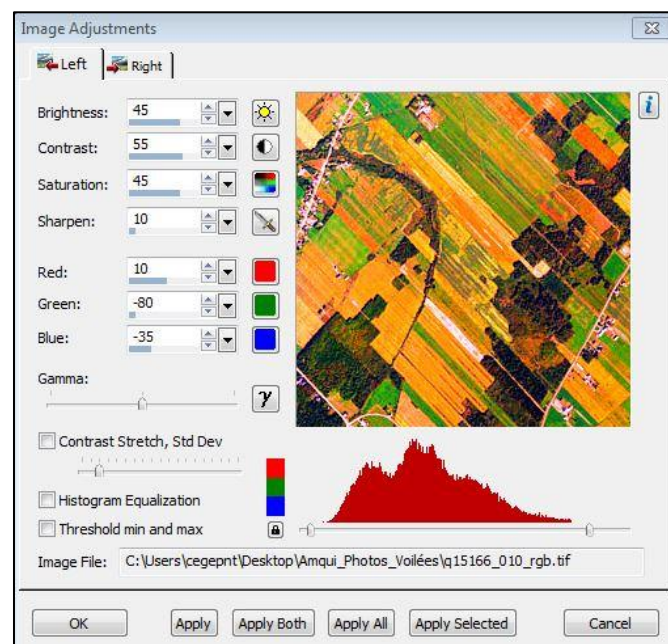
Figure 45. Paramètres de rehaussement pour correction d'une image avec dominance de jaune – Essai 1.
