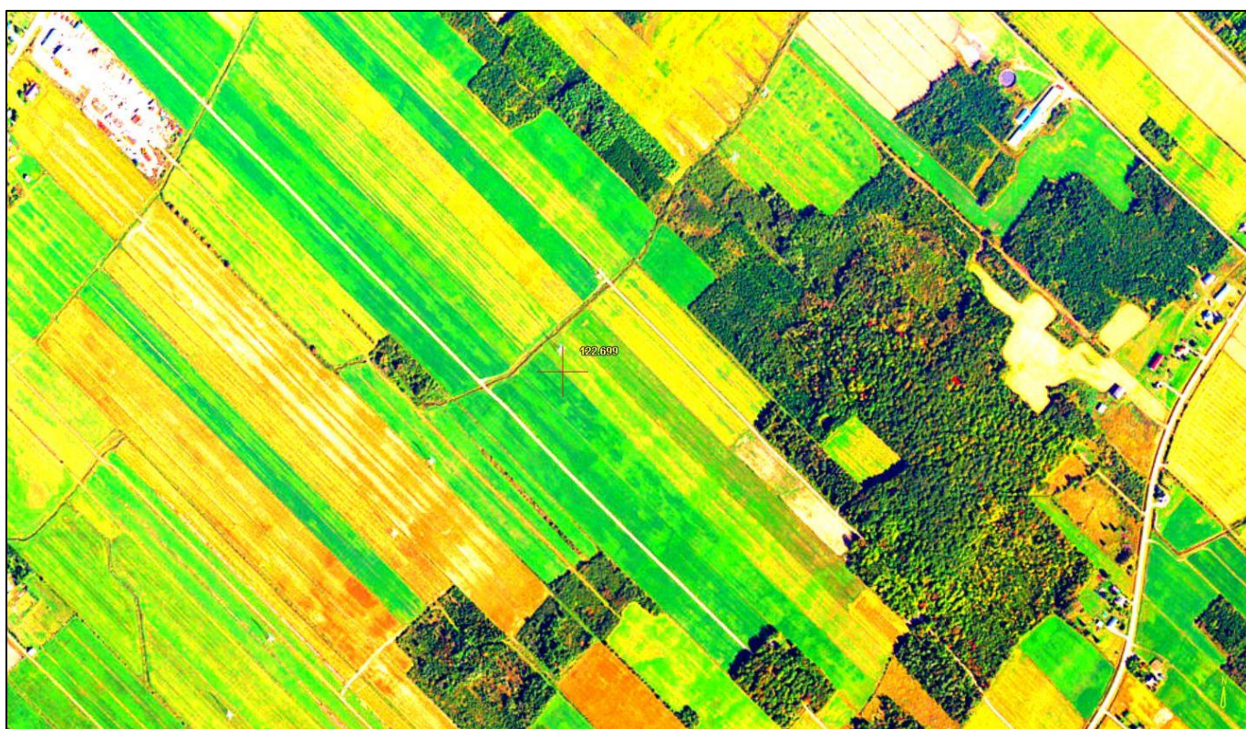
Figure 50. Exemple d'une photographie aérienne avec un rehaussement de base dans la sapinière à bouleau blanc de l'Est (paramètres de rehaussement : luminosité : 45; contraste : 55; saturation : 45; netteté : 10; rouge : 10; vert : -35; bleu : -35). Échelle approximative : 1/7000.
