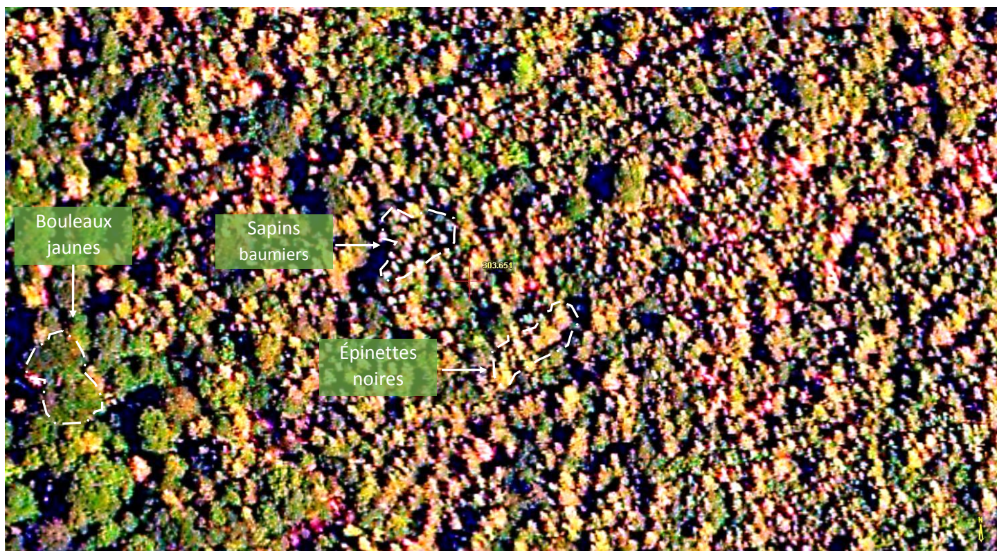
Figure 37. Exemple d'une photographie aérienne avec un rehaussement modifié (Essai 2) dans la sapinière à bouleau blanc de l'Est (paramètres de rehaussement : luminosité : 30; contraste : 55; saturation : 45; netteté : 10; rouge : 10; vert : -50; bleu : -35). Échelle approximative : 1/500.
