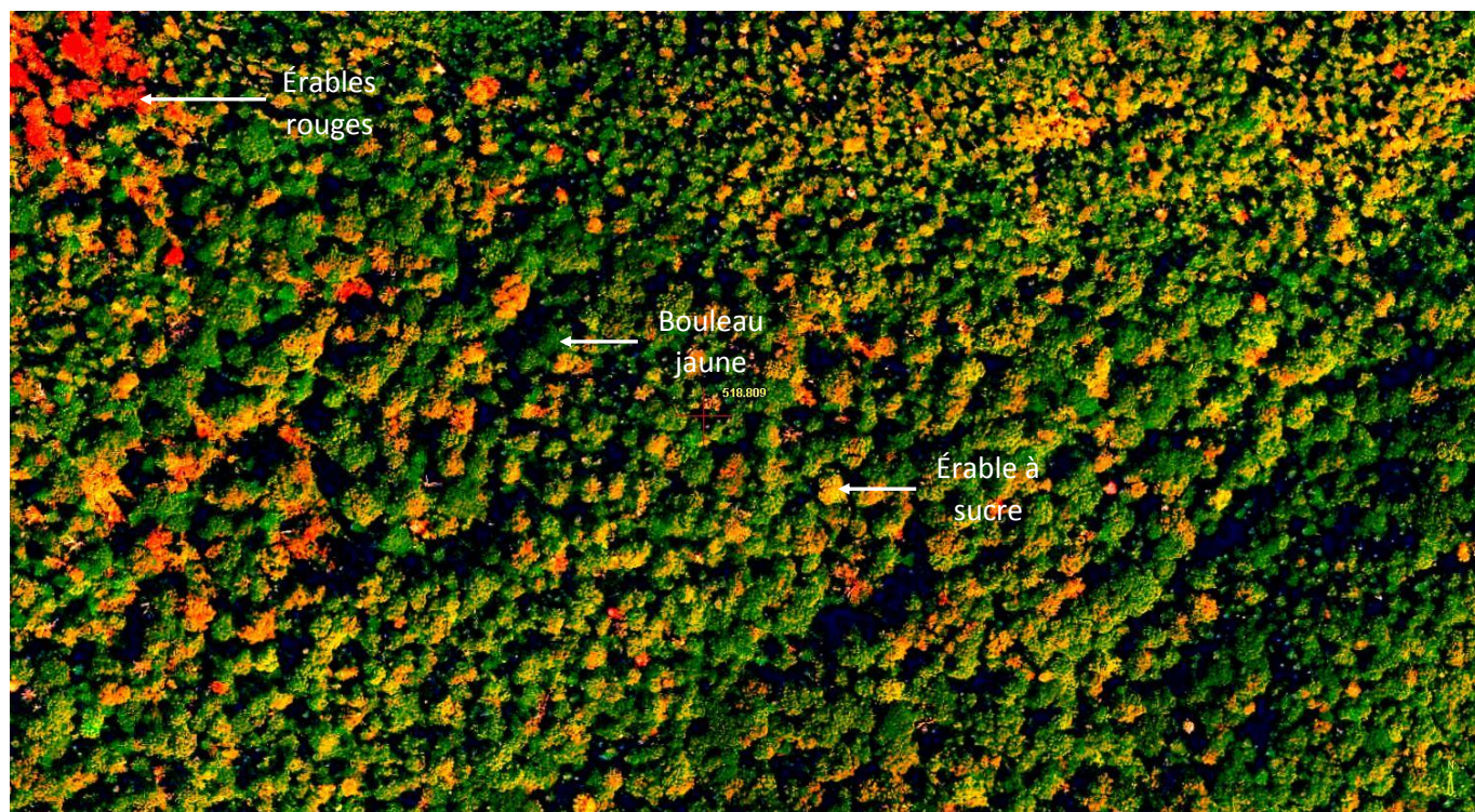
Figure 75. Exemple d'une photographie aérienne avec un rehaussement de base modifié (Essai 3 – feuillus) dans la sapinière à bouleau jaune de l'Est (paramètres de rehaussement : luminosité : 55; contraste : 75; saturation : 45; netteté : 10; rouge : 65; vert : -100; bleu : -100). Échelle approximative : 1/1000.
