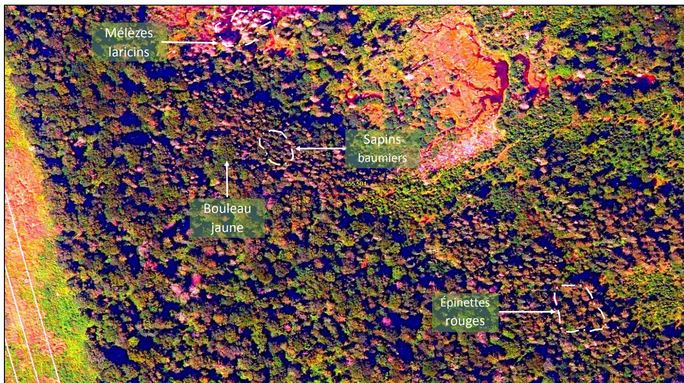
Figure 63. Exemple d'une photographie aérienne avec un rehaussement de base modifié (Essai 2) dans la sapinière à bouleau jaune de l'Est (paramètres de rehaussement : luminosité : 32; contraste : 70; saturation : 53; netteté : 10; rouge : 0; vert : -20; bleu : -35). Échelle approximative : 1/700.
