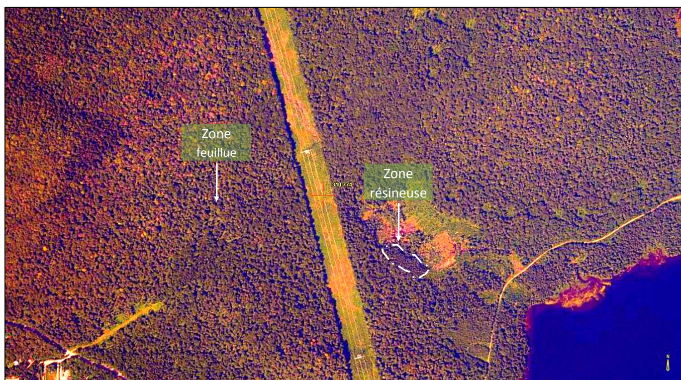
Figure 59. Exemple d'une photographie aérienne avec un rehaussement de base modifié (Essai 1) dans la sapinière à bouleau jaune de l'Est (paramètres de rehaussement : luminosité : 35; contraste : 55; saturation : 45; netteté : 10; rouge : 0; vert : -35; bleu : -35). Échelle approximative : 1/5000.
