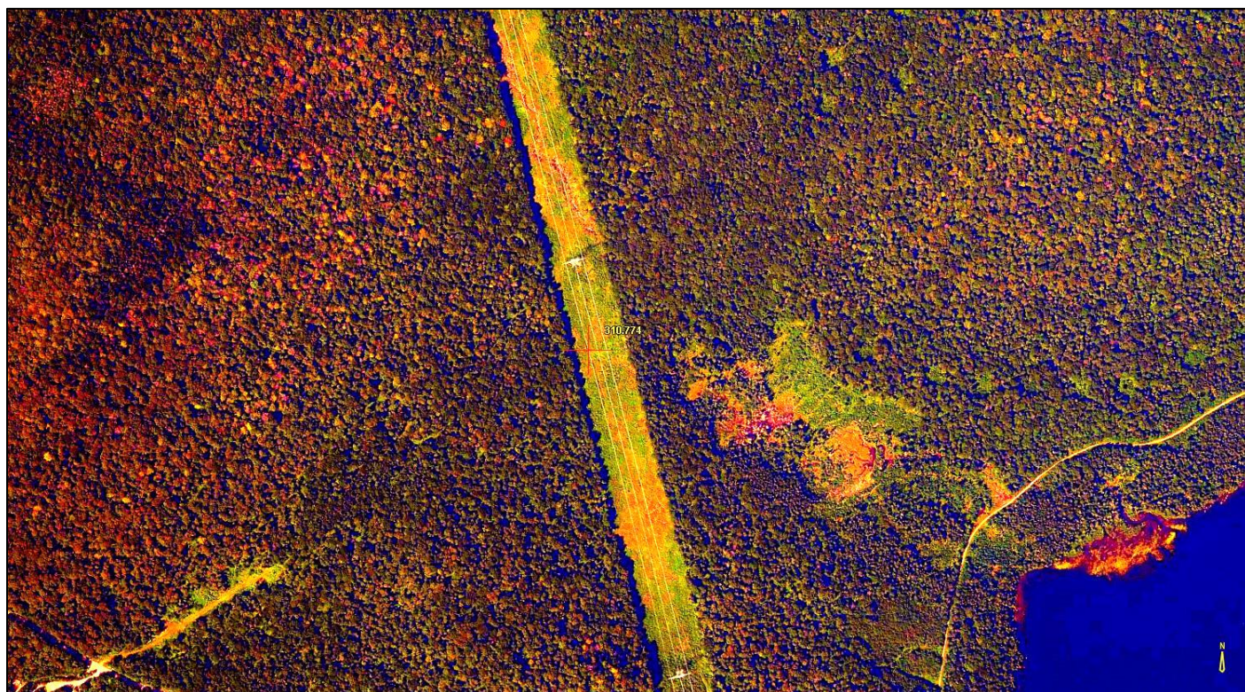
Figure 60. Exemple d'une photographie aérienne avec un rehaussement de base modifié (Essai 2) dans la sapinière à bouleau jaune de l'Est (paramètres de rehaussement : luminosité : 32; contraste : 70; saturation : 53; netteté : 10; rouge : 0; vert : -20; bleu : -35). Échelle approximative : 1/5000.
