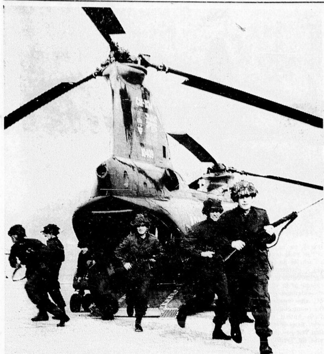
NOUVEL HELICOPTERE DE L'ARMEE — Des troupes du 2e bataillon des Canadian Guards se déploient en tenue de bataille en sortant du nouvel hélicoptère CH 113A Voyageur. Le Voyageur, une nouvelle acquisition de l'Armée canadienne, peut transporter 25 soldats complètement équipés, 15 blessés dans des litières, ou 5.000 livres de matériel sur une distance de 200 milles et à une vitesse de 150 milles à l'heure. Cette manœuvre s'est déroulée à l'aéroport de Rockcliffe, hier, alors que l'hélicoptère a été remis officiellement au ministre de la Défense nationale, M. Paul Hellyer. (Photo Défense nationale)
