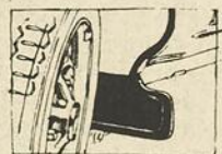
Doublures d'ailes en aluminium et bavettes anti-projections à l'avant.
