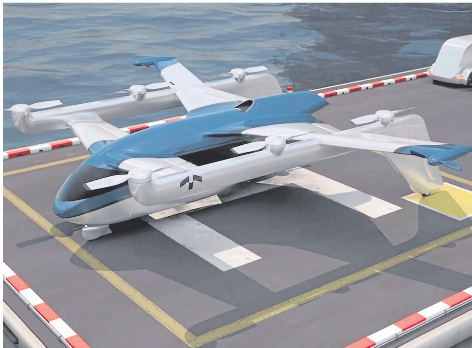
Le TF-2 de TerraFugia est un véhicule en trois parties qui comprend une cabine de passagers qui peut être transférée d'un véhicule routier à un véhicule aérien. — ILLUSTRATION FOURNIE PAR TERRAFUGIA
