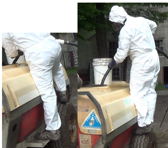
Figure 15. Contact des membres inférieurs avec la cuve du pulvérisateur lors de l'insertion des produits (Cas 1bis).
