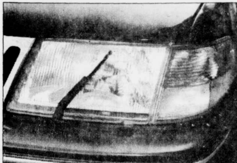
Comme d'autres modèles de grand luxe, la Saab 9000S dispose de lave-phares efficaces en équipement standard. C'est appréciable quand on roule dans la gadoue ou sur chaussée mouillée. Ils s'actionnent en même temps que lorsque l'on envoie un jet de lave-glace dans les essuie-glaces.
