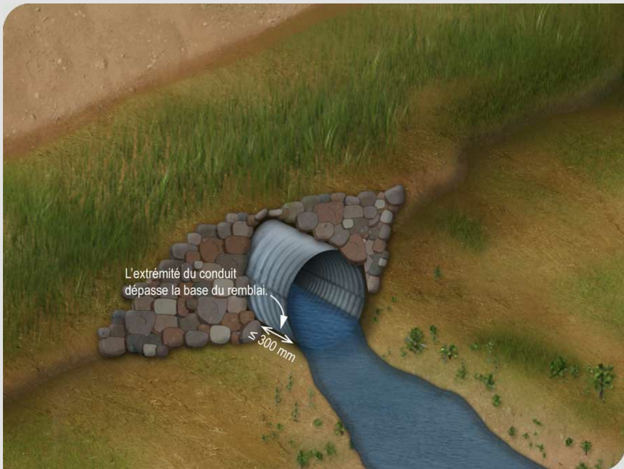
Figure 100A Dépassement de l'extrémité d'un conduit ou d'une arche par rapport à la base du remblai stabilisé
