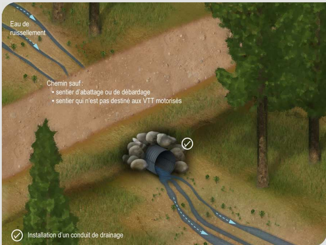
Figure 74 Installation d'un conduit de drainage pour permettre l'écoulement de l'eau d'un côté à l'autre du chemin
