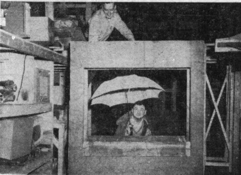
Ce cadre est la machine à faire la pluie. En haut, où se trouve Léo Poulin, il y a un auge percé de trous par où tombe la pluie. En bas, l'auge de récupération. En dessous tout à fait, la pompe circulaire actionnée par un moteur électrique, qui repompe l'eau à mesure.
