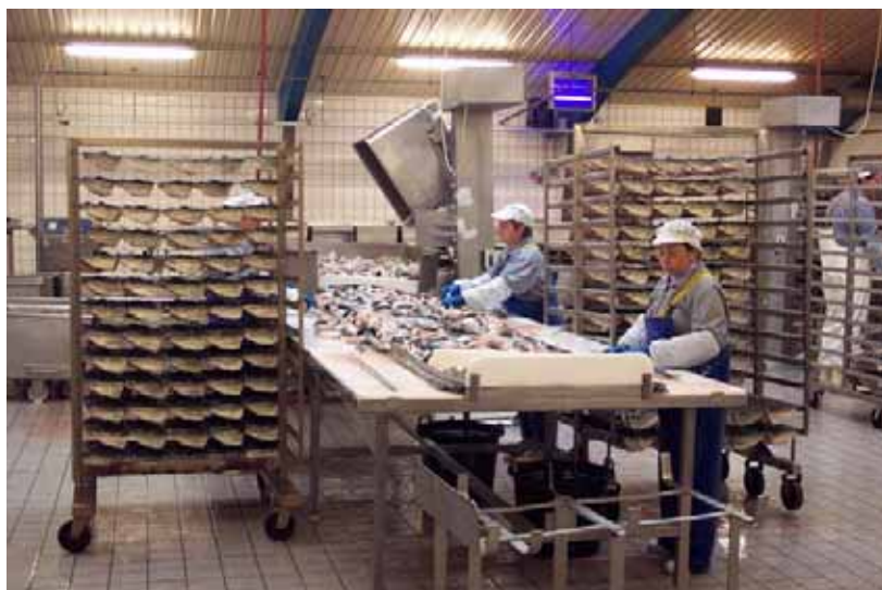
Figure 6. Mise en support de la truite pour le fumage chez Hevico
