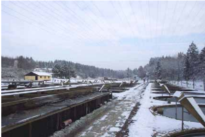
Figure 22. Station piscicole Tykskov Dambrug. On voit les bassins circulaires d'élevage à droite et l'unité surélevée de traitement des eaux à gauche
