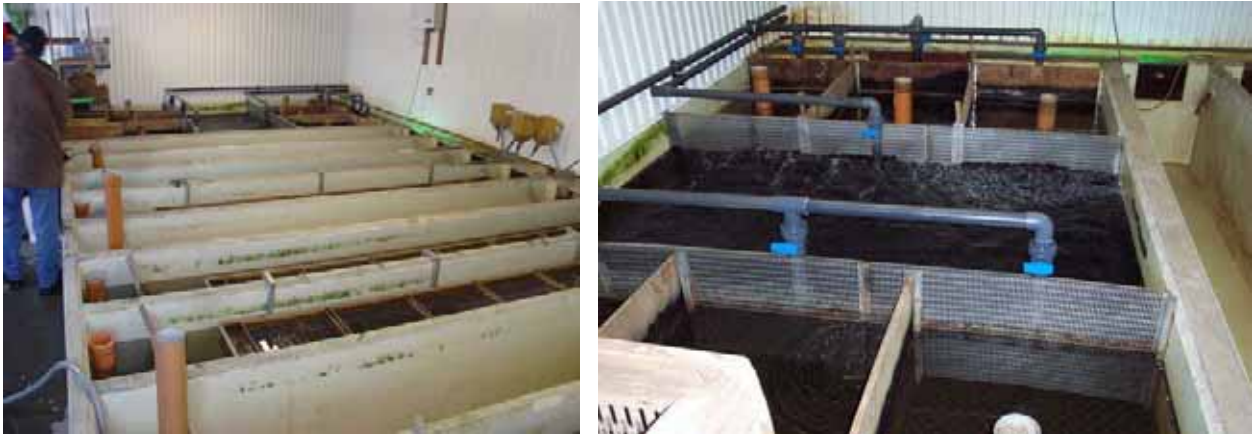
Figure 24 Installation d'alevinage à la ferme Oxfeld Dambrug. On voit sur la photo de gauche les unités d'élevage occupées par des auge contenant des œufs. La photo de droite montre le système de traitement d'eau
