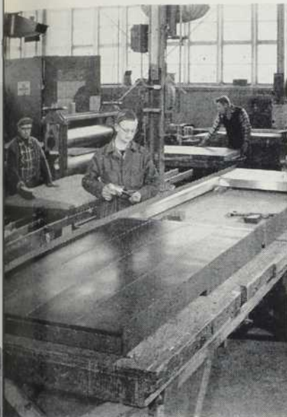
L'assemblage en ligne des panneaux signifie fabrication de précision — aucun ajustement sur le chantier.
