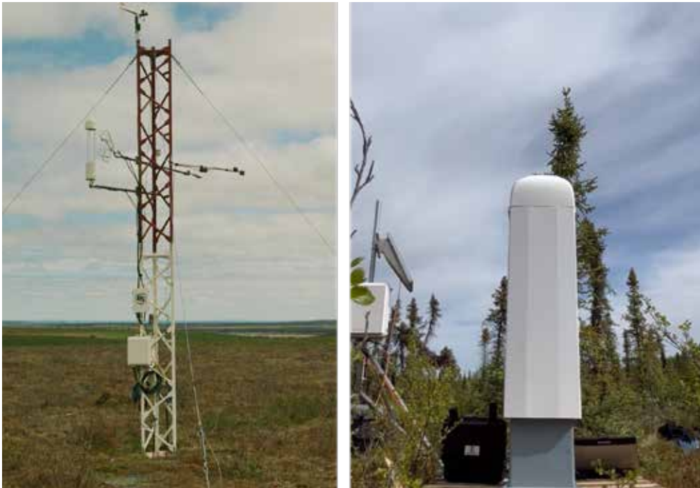
Figure 1. Instruments de mesure pour l'analyse des changements de matière et d'énergie entre sol et ciel. À gauche : tour de covariance des turbulences ; à droite : cénomètre. Source : Bruno Lecavalier.
