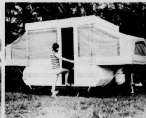
En 1971, une tente-roulotte encore améliorée que les produits Lionel offrait au public. A cette époque, les bras extérieurs étaient la toute nouvelle conception pour lever le toit de la tente-roulotte. Aujourd'hui, on procède à l'aide d'une manivelle.
