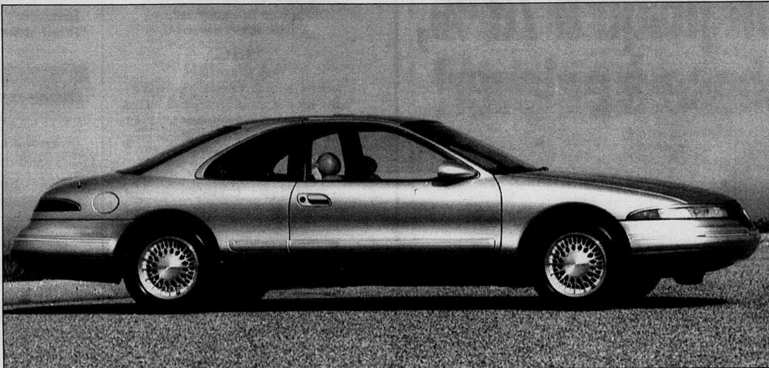
La nouvelle Lincoln Mark VIII pourra se mesurer à des coupés de luxe bien établis grâce à son nouveau V8 de 4,6 litres à 32 soupapes et deux arbres à cames en tête.
