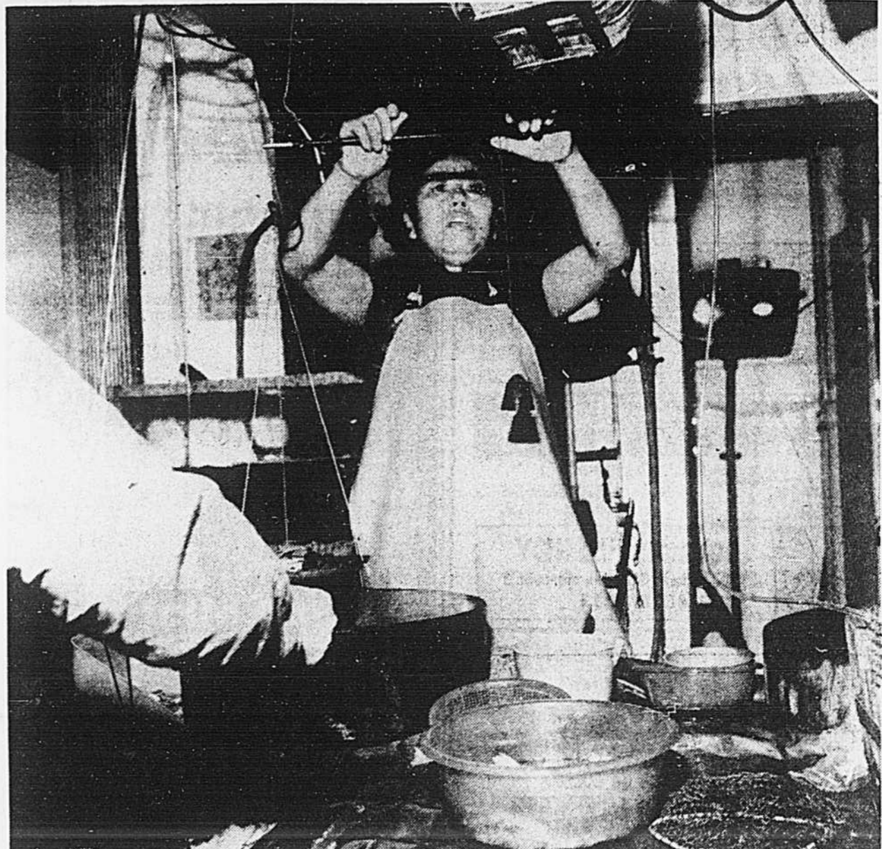
Une femme pèse du poisson frais dans un marché ouvert de Hong-Kong, à l'aide d'une vieille balance chinoise. Une pièce de bois retient deux boucles, l'une pour le poids et l'autre pour l'objet à peser. La mesure utilisée est le catty chinois (un catty = 1.3 lb). On déplace la boucle et le poids selon le produit le long d'une balance graduée jusqu'à équilibre parfait de la pièce de bois soutenue en son centre.
