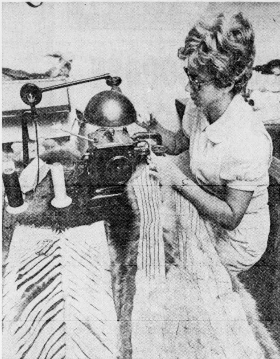
A l'aide d'une machine à coudre spéciale, chacune des entailles faites dans les peaux est recousue, en allongeant les peaux.
