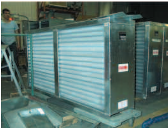
3.17 Récupérateur à tuyaux thermique
