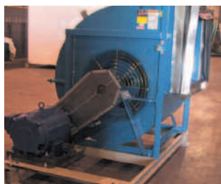
1.10 Ventilateur d'alimentation type centrifuge
