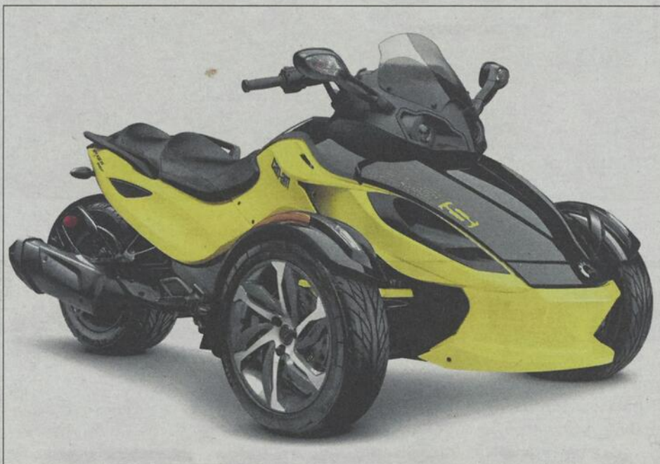
Le Spyder RS-S est le plus sportif de la gamme Can-Am. Il est animé par un bicylindre en V Rotax de 998 cm 3 (100 ch). 0-100 km/h en 4,5 s.
