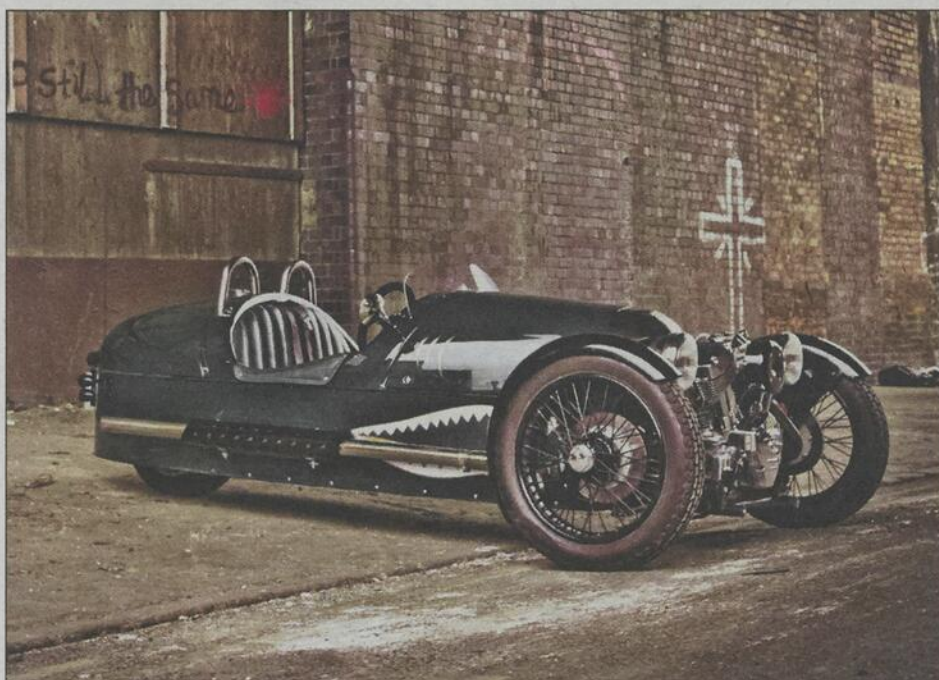
Le Morgan Threewheeler fait un clin d'oeil aux années 1930. Il pèse 525 kg et son moteur est un bicylindre en V de 1976 cm 3 (82 ch). 0-100 km/h en 5,9 s.
