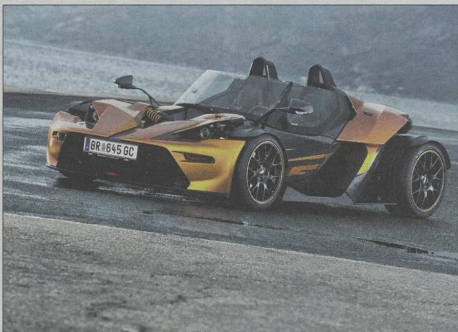
Le X-Bow de KTM est propulsé par un L4 turbo de 2,0 l (281 ou 296 ch, selon la version). Son poids varie de 790 à 847 kg. 0-100 km/h en 3,9 s.
