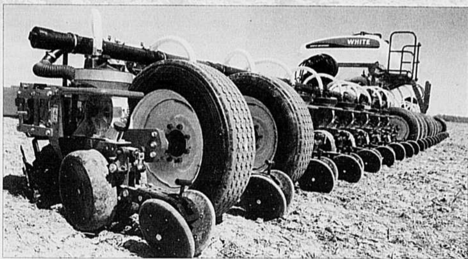
La fenêtre de semis étant restreinte, le soya et le maïs sont souvent mis en terre simultanément. Ce nouveau planteur de 24 rangs sert principalement aux semis du soya.
