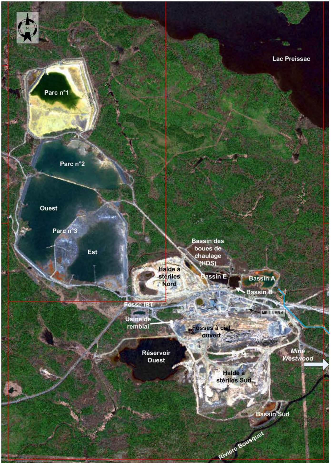
Annexe 2-C.1 : Localisation des lieux de dépôt ou d'entreposage de matières résiduelles dangereuses et non dangereuses et de résidus miniers – parcs à résidus et halde de stériles
