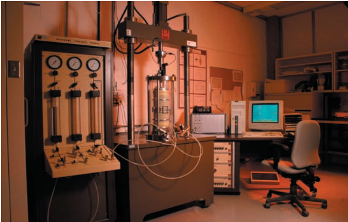
Figure 1 : Équipement triaxial à chargement déviatorique répété
