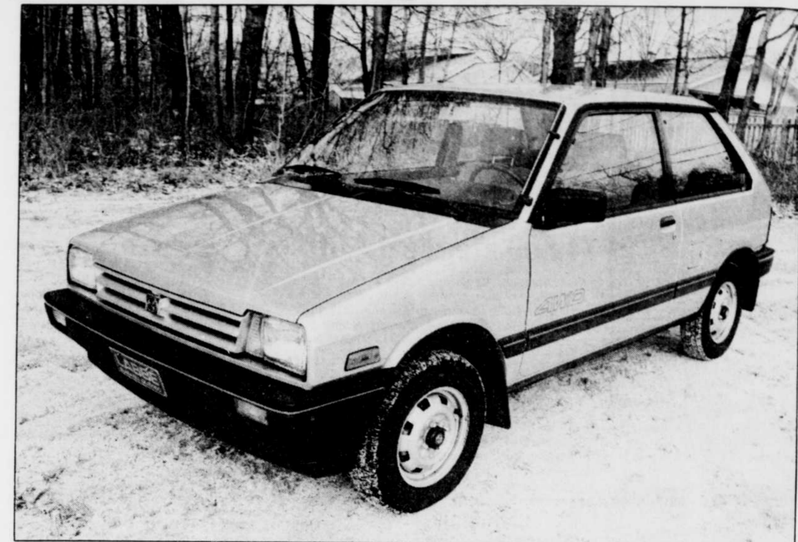
La Subaru Justy est équipée d'une transmission à changements de vitesses continus qui ne comporte pas de pignons, le système faisant appel ici à une courroie d'acier flexible courant sur deux poulies pour permettre le passage en continu d'un rapport à l'autre.
