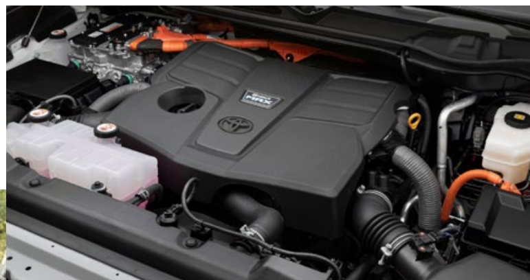
Le V6 Hybride de 3,5 L (i-Force Max) du Toyota Tundra
