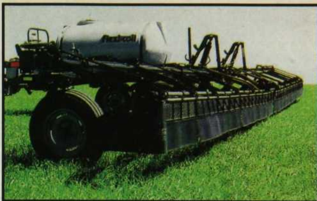
L'écran protecteur monté sur la rampe Flexi-Coil réduit considérablement la dérive.
