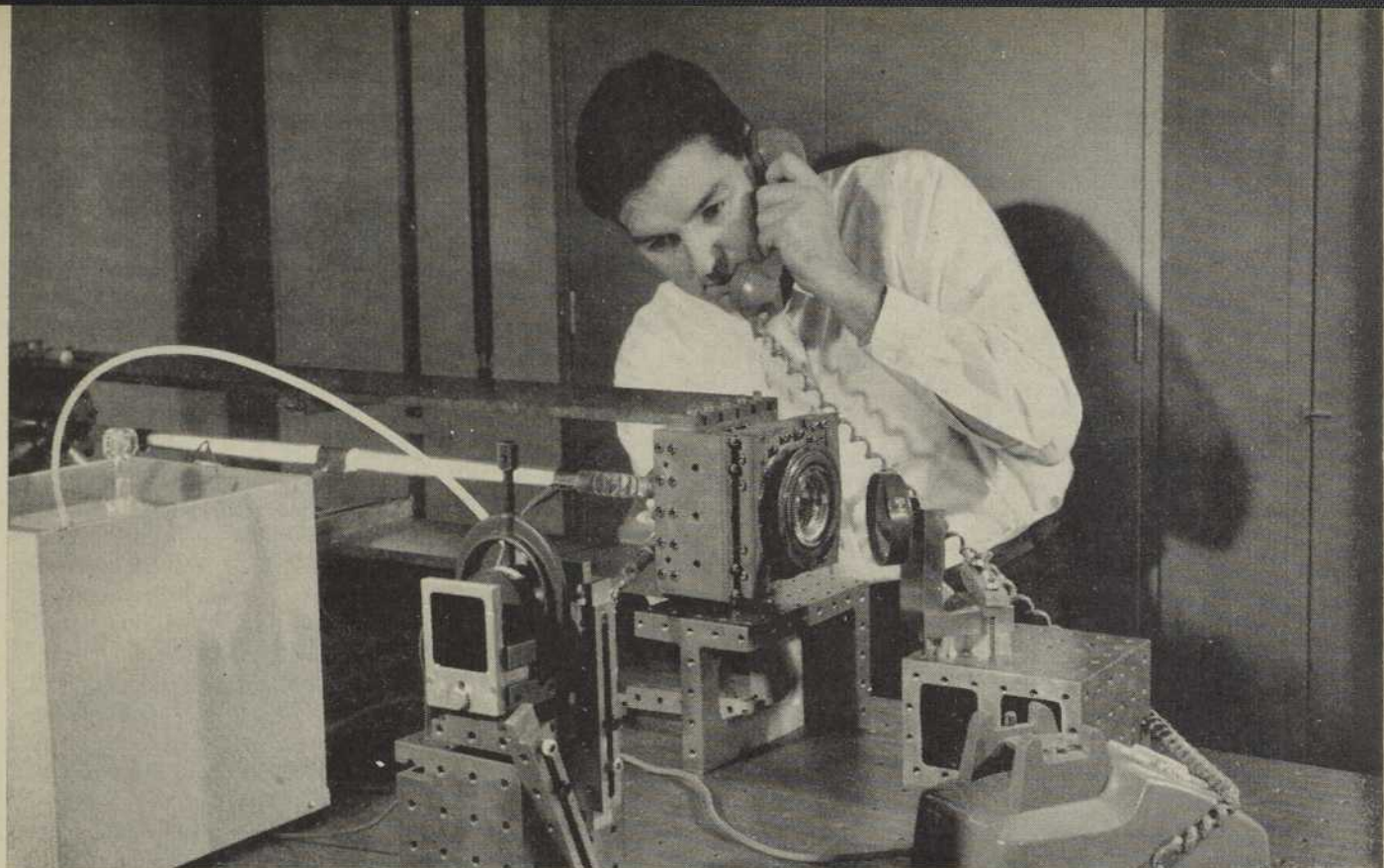
Un chercheur des Laboratoires Bell, Donald R. Herriott, montre comment on fait l'impression de conversations téléphoniques sur un rayon cohérent de lumière infra-rouge formé par l'opération continue du maser optique à gaz. La lumière cohérente peut être faite pour porter l'intelligence aussi bien que des ondes de radio.
