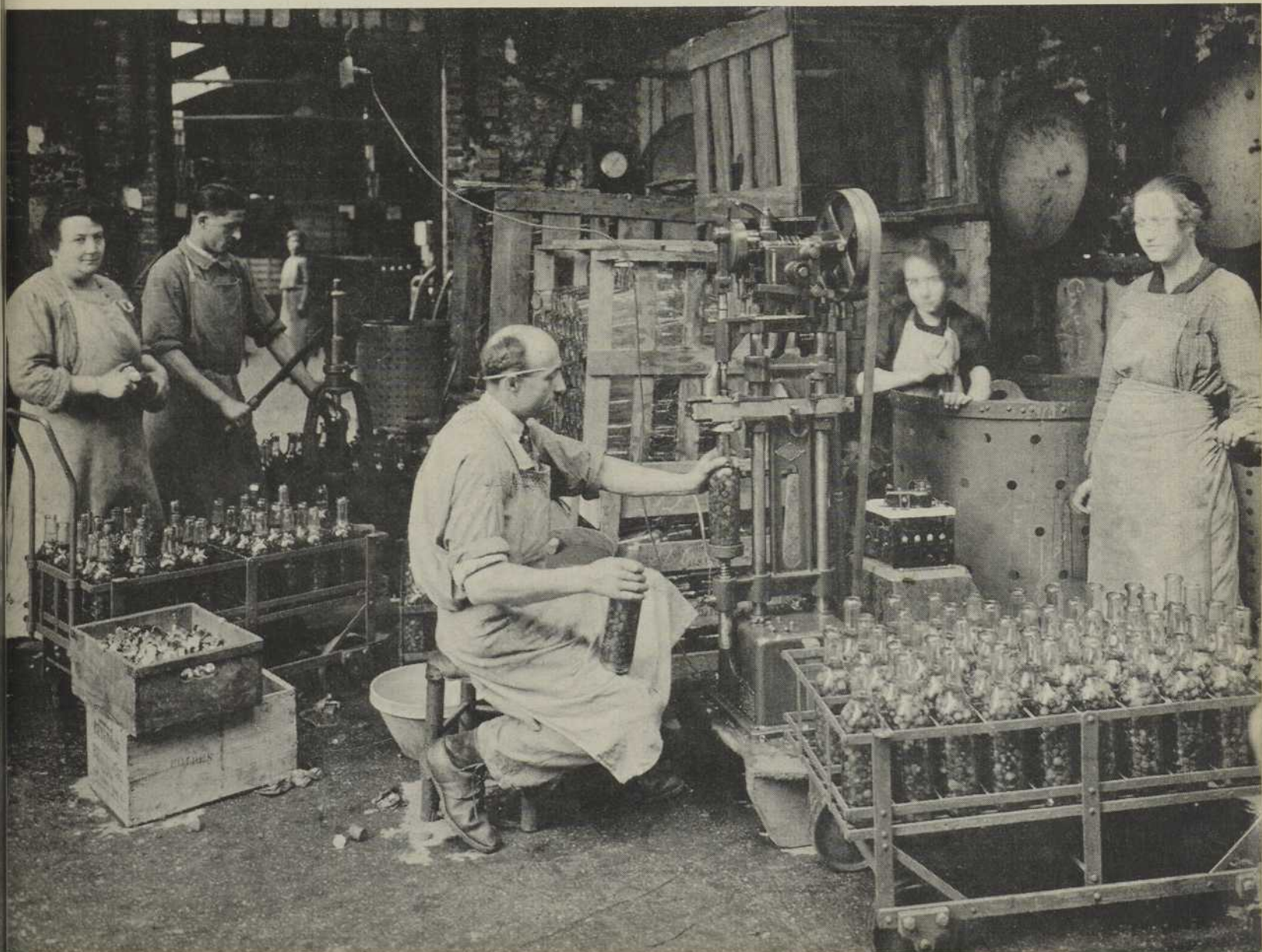
LE BOUCHAGE MÉCANIQUE DES BOCAUX DE CERISES DEMANDE LA COOPÉRATION DE PLUSIEURS EMPLOYÉS.
