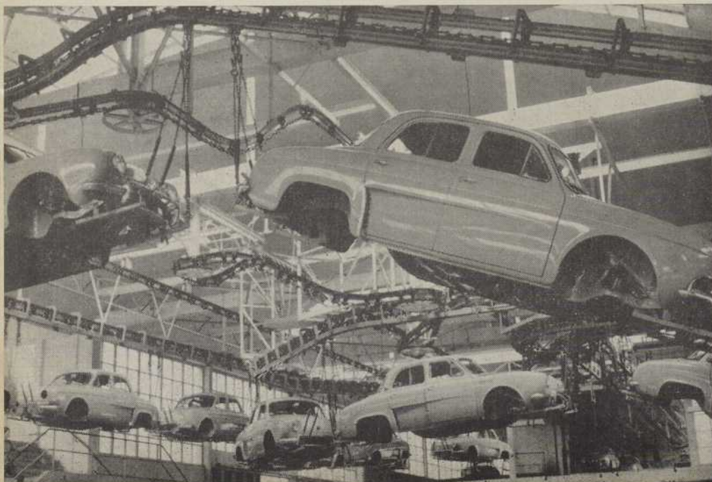
Usines de Flins: poste d'aiguillage automatique. — Venant de l'atelier de sellerie, où elles ont reçu les garnitures et les accessoires, les carrosseries sont réparées, par un système d'aiguillage automatique, sur les deux lignes de finition.
