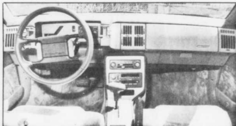
La planche de bord accueille en son centre les commandes de ventilation, qui s'avère efficace, mais aussi une instrumentation plus ou moins visible. (Flageol Photo - Roméo Flageol)
