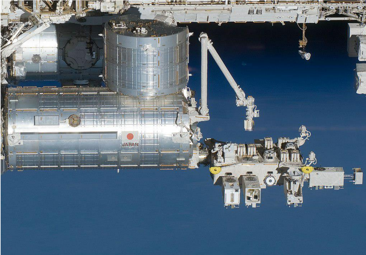
La grande réalisation spatiale nippone: le laboratoire scientifique Kibo, rattaché à la Station spatiale et muni d'une plate-forme extérieure et d'un bras télémanipulateur.
