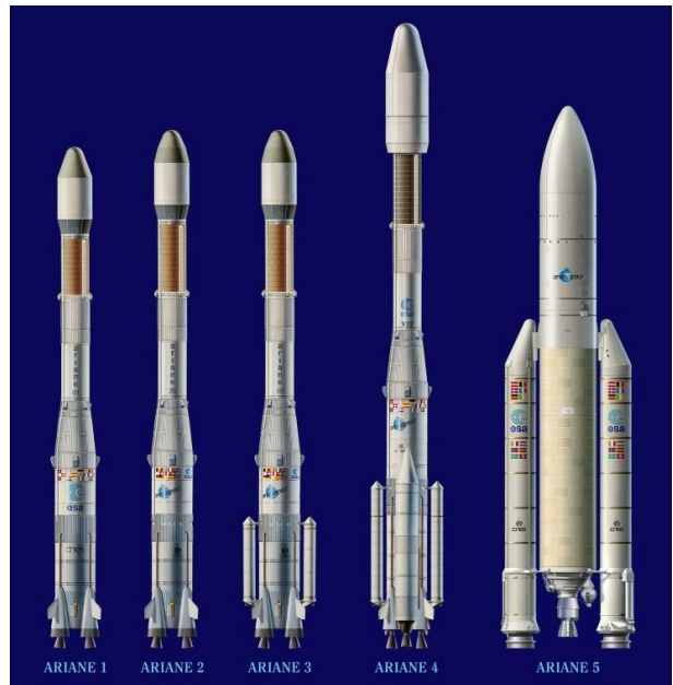
Les cinq versions de la fusée Ariane: d'Ariane 1, d'une hauteur de 47,4 mètres et capable de placer deux tonnes sur orbite, à Ariane 5, d'une hauteur de 55 mètres et capable de placer de 18 à 21 tonnes sur orbite.
