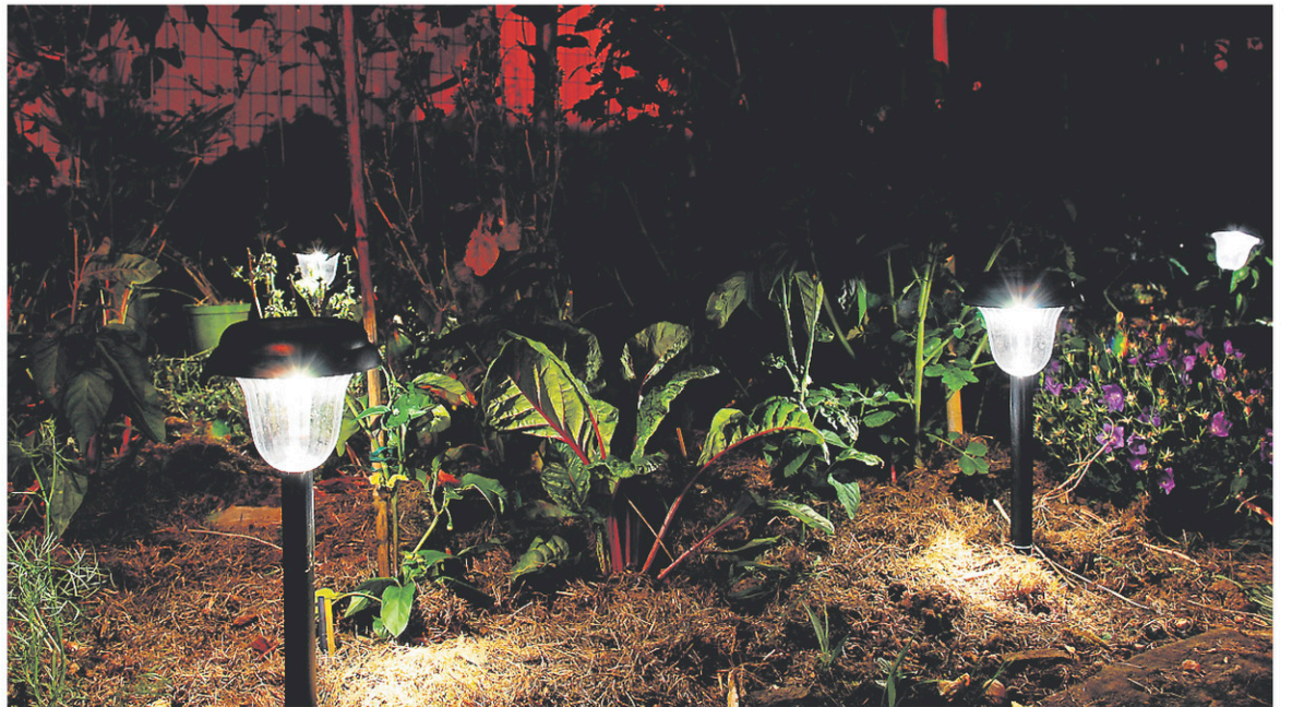
L'éclairage extérieur solaire est une magie qui se répète jour après jour, à la tombée de la nuit, lorsque les piles de ces appareils, gorgées de rayons solaires transformés en énergie par les cellules photovoltaïques, s'activent et font s'allumer automatiquement les ampoules. — PHOTO 123RF/JOJOB
