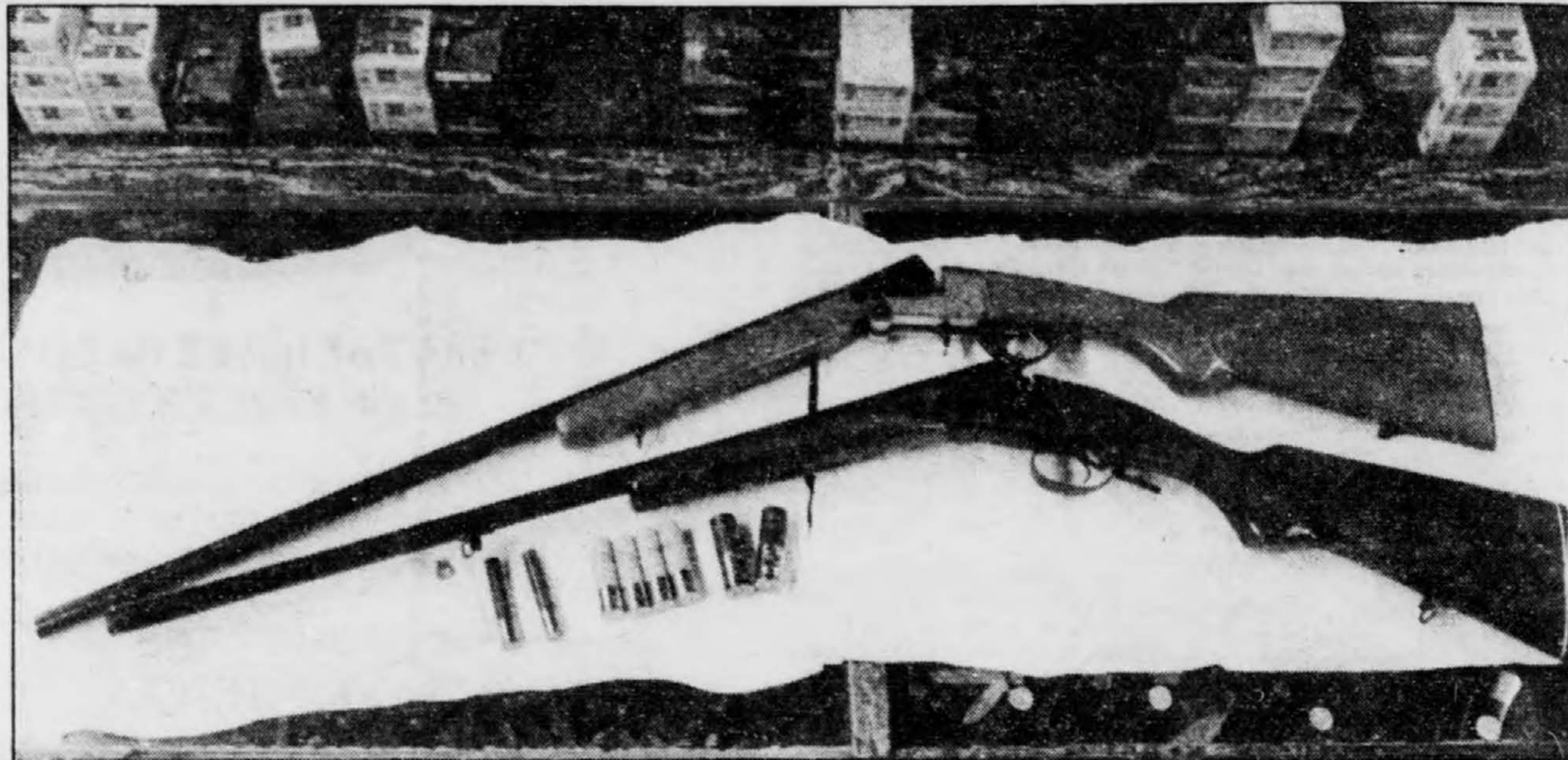
Un grand nombre d'armuriers considèrent que l'arme de chasse idéale à offrir à une jeune est le fusil de calibre 20. Le 410, disent-ils, devrait être réservé aux tireurs experts. Ci-dessus, un 410 (en haut) et un 20 (sans marteau extérieur) de même que des munitions de calibre 410, 20 et 12.
