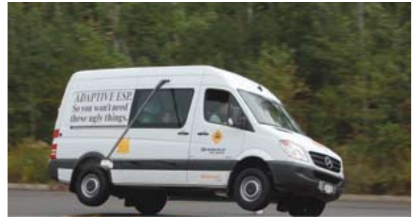
Un Sprinter, spécialement modifié, permet de faire l'expérience du comportement dynamique d'un véhicule chargé avec, et sans, dispositif électronique de stabilité.
