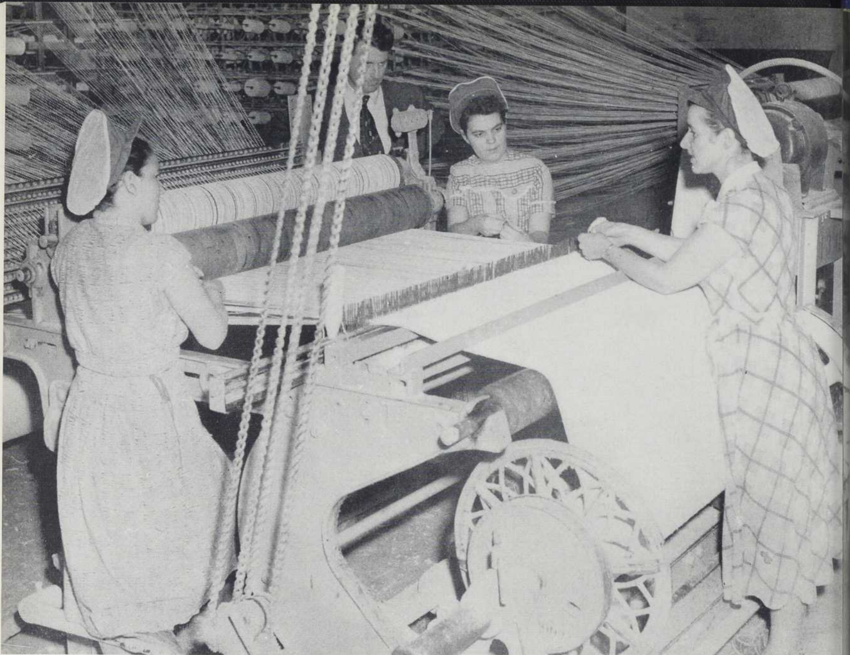
Fibre d'amiante enroulée sur l'ourdissoir avant le tissage. L'amiante se tisse aussi aisément que la laine et le coton et se prête à des milliers d'usages. La province de Québec fournit les deux tiers de la production canadienne dans l'industrie des articles d'amiante.
