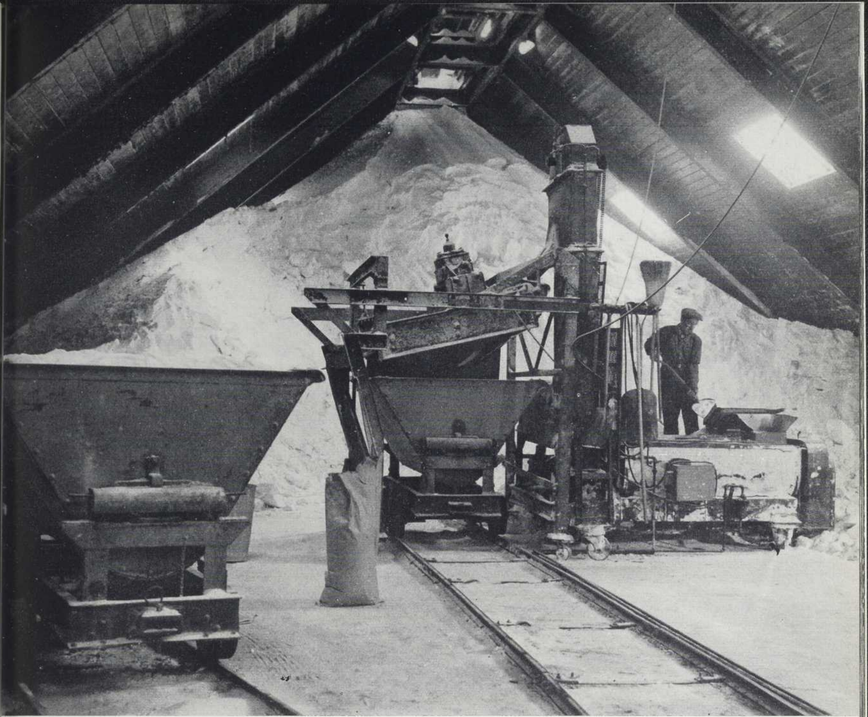
Broyage et tamisage du nitrate de sodium, l'un des ingrédients qui entrent dans la fabrication de la dynamite. Les explosifs sont classés dans le secteur des produits divers de l'industrie chimique.
