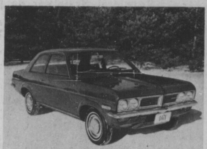
Firenza, c'est le nom de la nouvelle voiture compacte économique conçue pour le marché canadien qui sera bientôt présentée par General Motors. La Firenza 1971 sera offerte en deux versions, dont une familiale. Elle sera équipée d'un moteur à quatre cylindres, à arbre à cames en tête, de 1975 cm 3 et de servo-freins avec disques à l'avant en équipement standard. Son empattement sera de 97 pouces.
