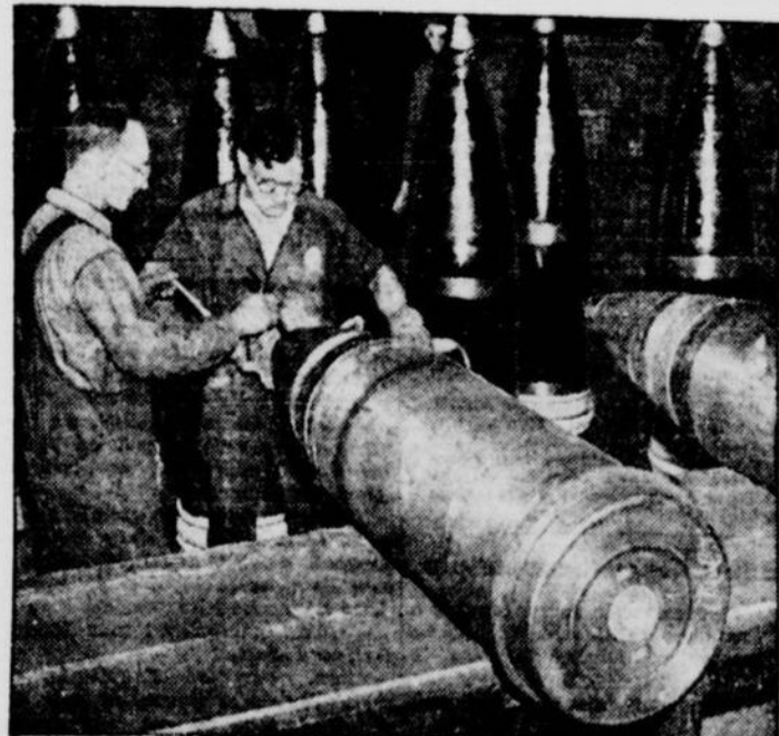
Ces gigantesques obus, assez puissants pour percer des carapaces d'acier blindé, sont manufacturés à la Bethlehem Steel, Pennsylvania. Ils sont lancés par des canons de seize pouces.
