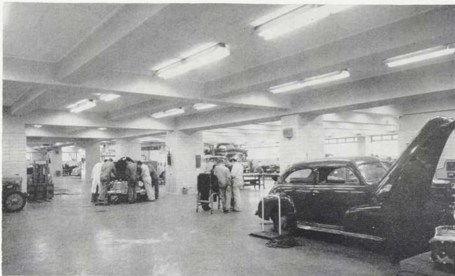
Le garage, au rez-de-chaussée. Un groupe d'élèves s'affairent autour d'une voiture alors qu'un professeur surveille et explique l'opération. Des bouches de branchement, au plancher, permettent d'y connecter les tuyaux d'échappement alors que les moteurs sont en mouvement.
