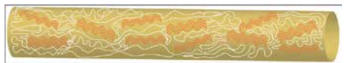
FIGURE 5. Modèle simple de la soie ampullacée majeure. Les domaines rouge orangé correspondent aux nanocristaux et les domaines blancs à la phase amorphe. Adapté de Termonia 1994.
