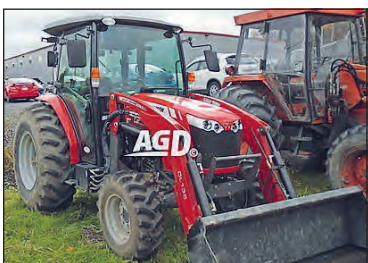
2015 MASSEY FERGUSON , Tracteur, cab., chargeur, transm. 12X12 Power shuttle, 59 forces, modèle 1759L
