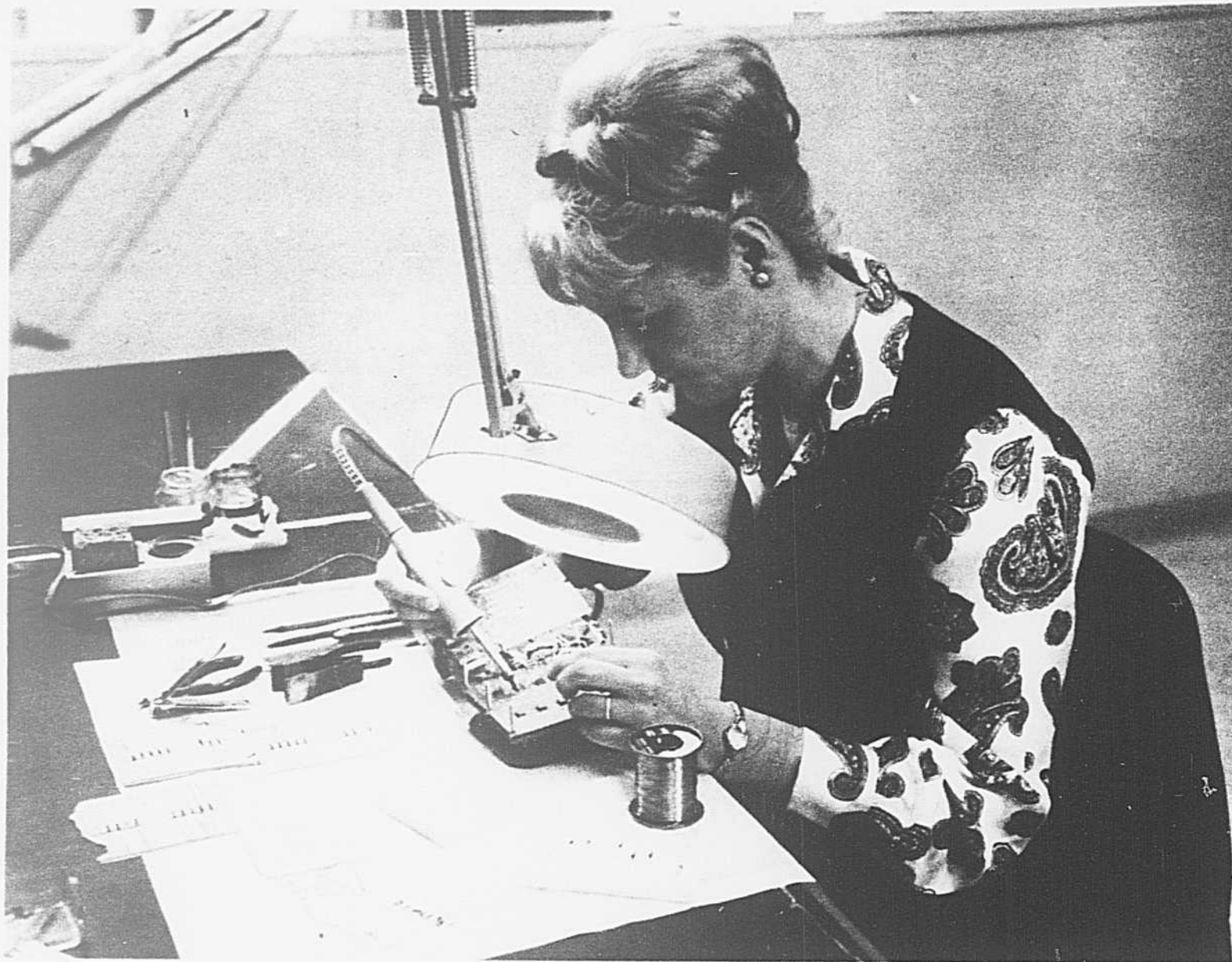
L'équipement électronique d'un satellite doit être construit avec la plus parfaite précision. C'est pourquoi tous les circuits sont montés à la main, et maintes fois vérifiés.
