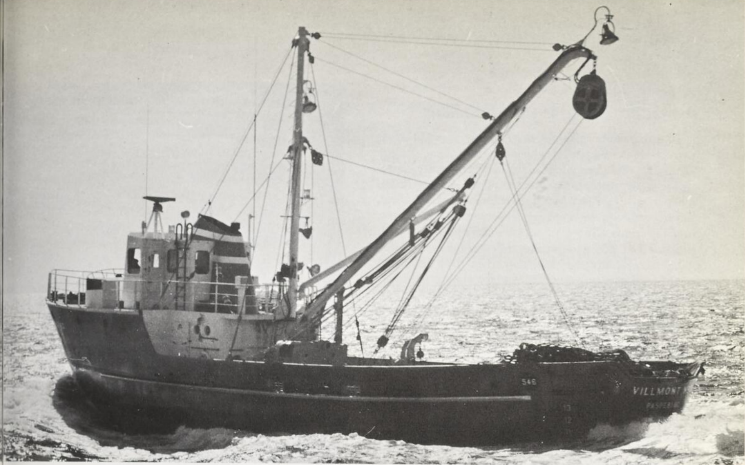
Chalutier-senneur équipé pour la pêche aux poissons de fond et aux poissons pélagiques.
