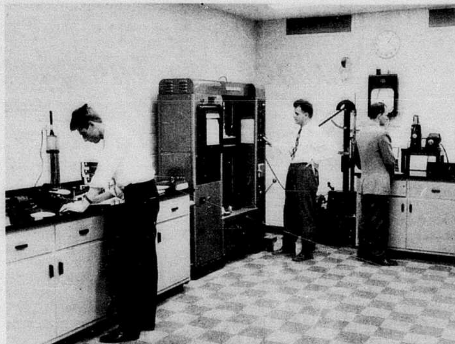
Le vérificateur Instron sert à des expériences sur la force de tension du papier, de morceau de bois, de filament et d'autres matériaux.
