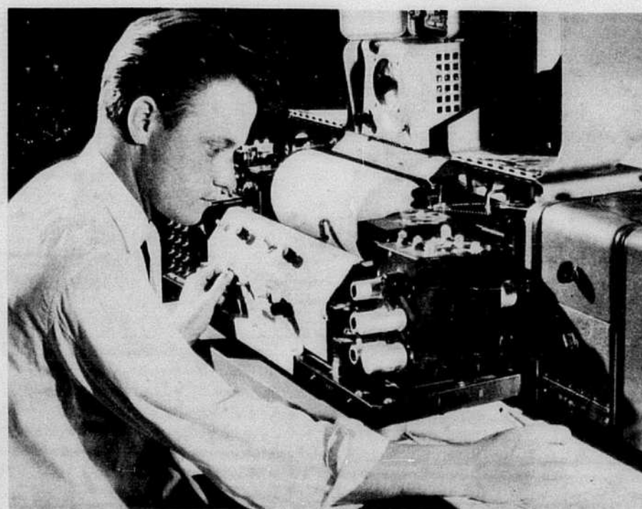
Un spectrophotomètre est utilisé pour l'analyse optique des solutions et des solides grâce à leur puissance d'absorption des rayons ultra-violet.
