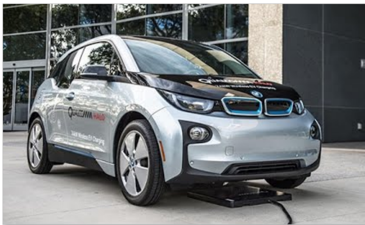
Figure 2 : Système de recharge par induction statique [17]
