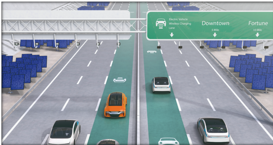
Figure 11 : Recharge par induction dynamique [50]
