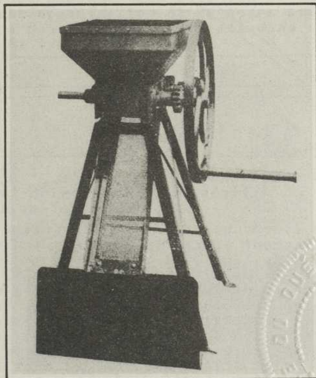
Fig. 14.- Concasseur à main (cliché de Vélard)
