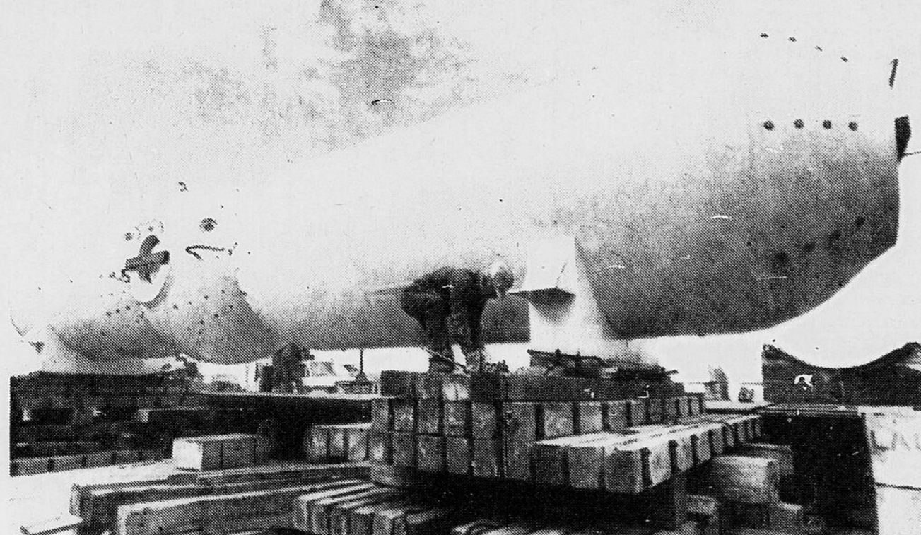
INSTALLATION — Une chambre pressurisée capable de simuler une plongée plus profonde que un mille sera livrée au Defense and Civil Institute for Environmental Medicine, à Toronto. Cette chambre de 170 tonnes est unique au monde. Elle peut soumettre des
