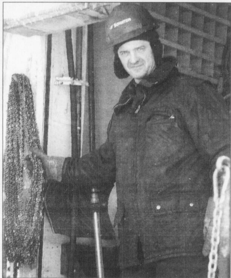
ENTRETIEN - Patrice Gauthier explique que la chaîne installée sur la lame de la tête d'abattage se gâte facilement. Il en faut une vingtaine par semaine.
