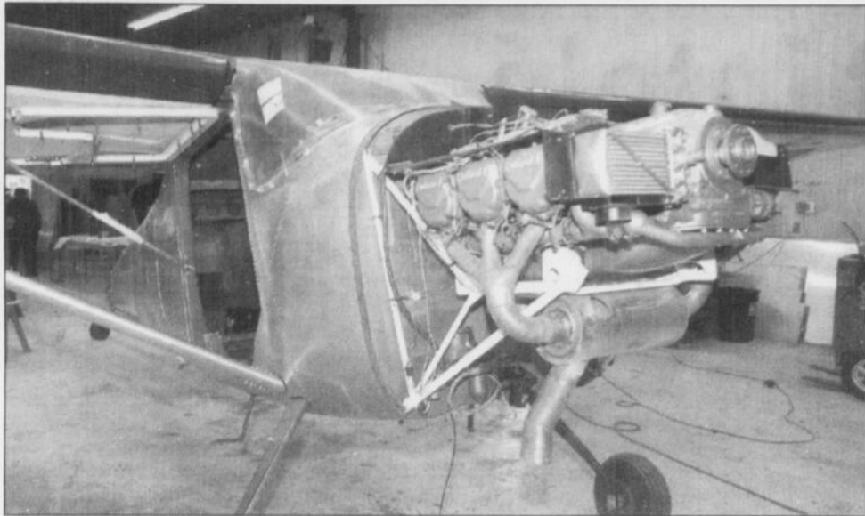
MOTEUR - L'avion de brousse almatois est animé par un puissant moteur de marque Continental, disponible en version 230 ou 300 forces.
