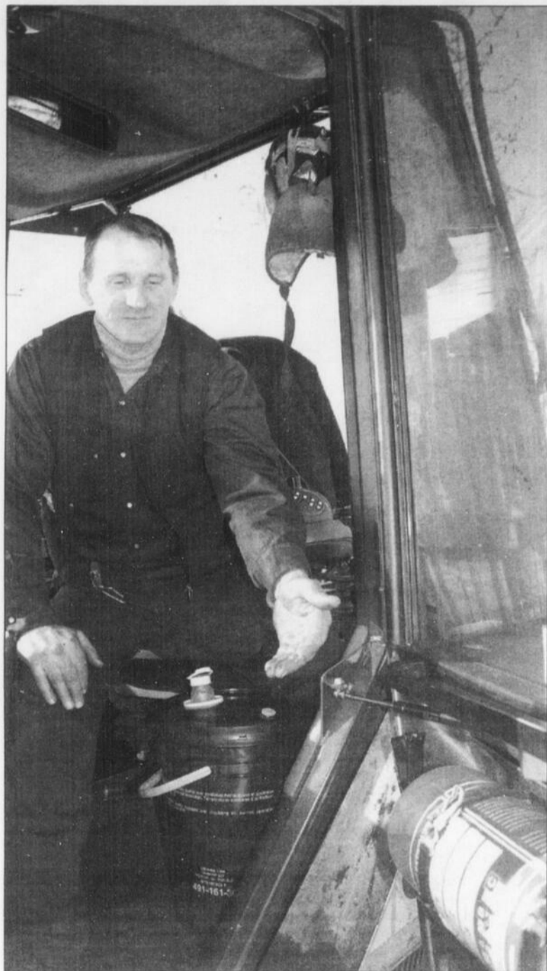
POUSSIÈRE - L'opérateur de bûcheuse multifonctionnelle Raynald Lavoie montre comment la poussière de suie s'accumule partout dans les machines.
