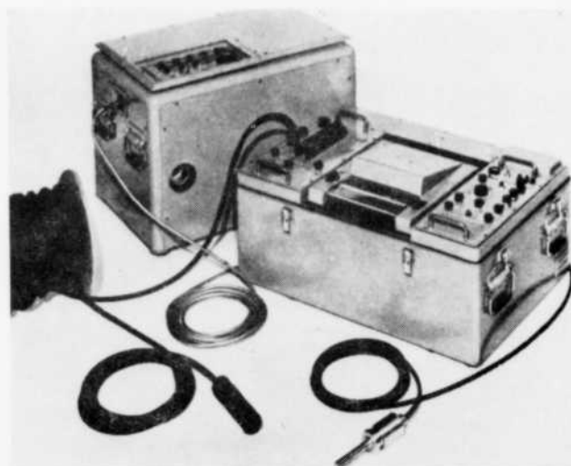
Hydrosonde pour mesurer le profil des fonds marins
