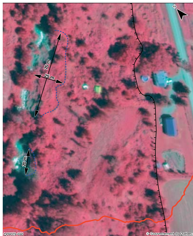
Figure 5.4 Agrandissement de la photographie aérienne d'août 2009 d'un secteur instable en pied de talus.
