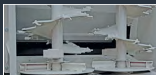
Les batteurs verticaux VertiSpread offrent un épandage large et homogène
