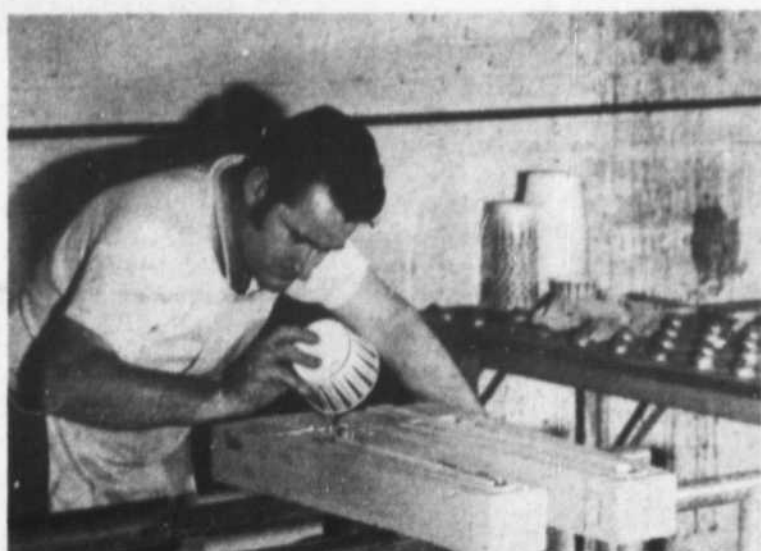
Denis Baril coule du polyurethane dans les moules de caoutchouc.
