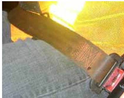
Figure 13. Sangle, à l'origine de couleur orange, exposée à un environnement salissant.
