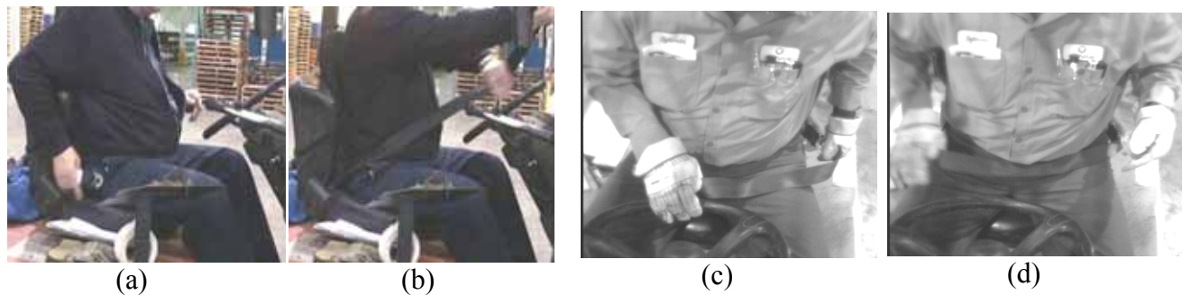
Figure 14. Phases typiques du bouclage à deux mains avec les rétracteurs ALR ou ELR.
