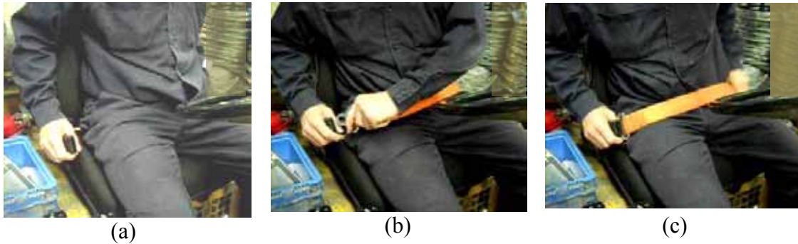
Figure 15. Bouclage lorsque la boucle n'est pas fixée rigidement (rétracteur ALR).
