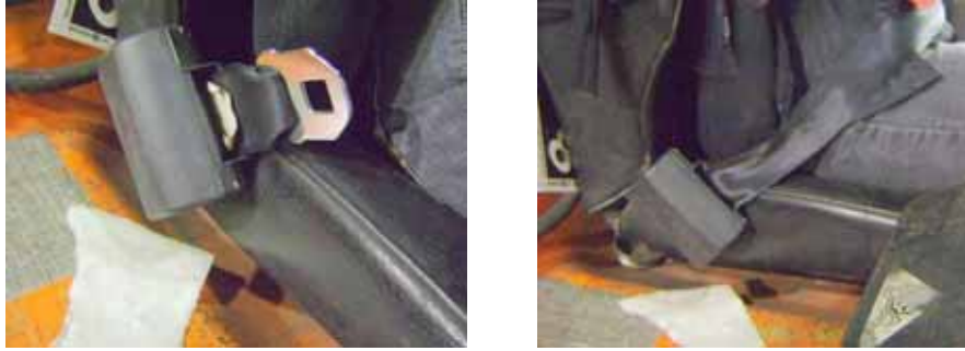
Figure 20. Ceinture dont le rétracteur ALR et la sangle sont souvent sujets au blocage.
