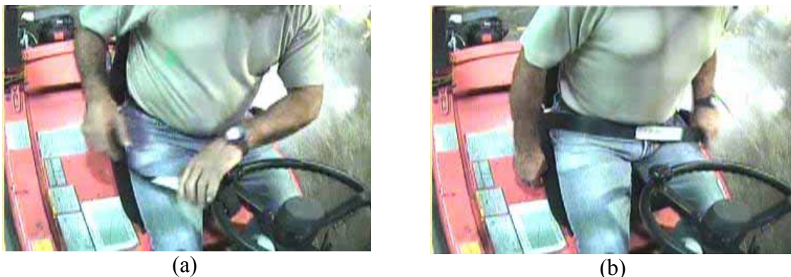
Figure 17. Phases typiques du bouclage avec le rétracteur manuel – sans ajustement.
