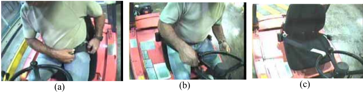
Figure 19. Débouclage de la ceinture à rétracteur manuel.
