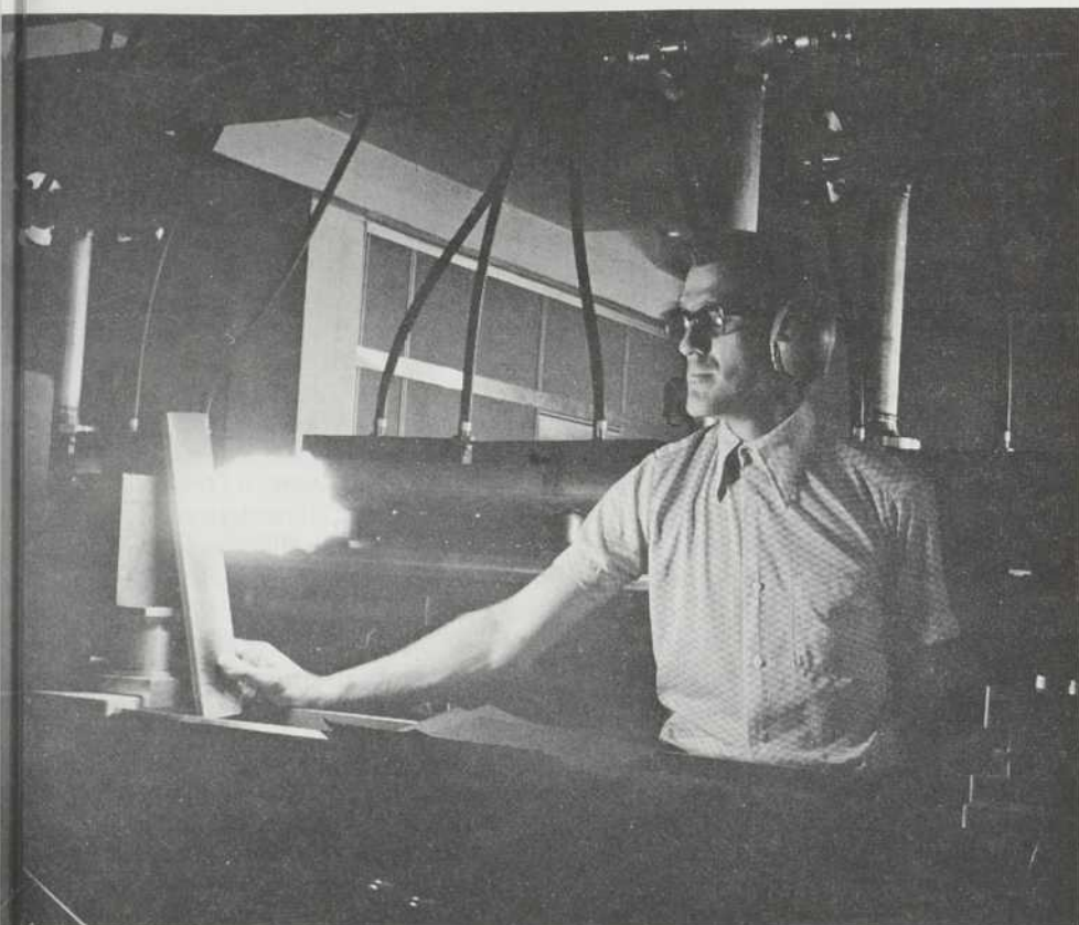
◁ Inflammation superficielle d'une planche sous l'action d'une impulsion de 150 joules et de 50 nanosecondes, au CRDV. Un plasma formé à la surface du bois amorce la combustion du bois.
