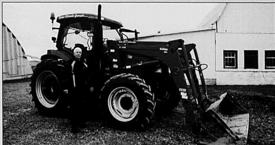
Voici M. Dulude devant un chargeur Buhler. Il nous indiquait que le contrôle automatique du niveau du godet est souvent perceptible par l'ajout d'un deuxième point de pivot au dessus du bras principal.
