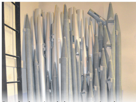
Pour les besoins de la restauration de l'orgue, l'ensemble des pièces a été démonté, dont le jeu de tuyaux sonores.
